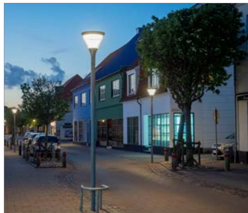
Sky Park armaturet på en cylindrisk mast Ø90 mm med indfarvet afstandsring.
