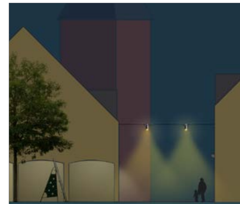
Illustrativ opstalt af Torvestræde med G-Cat armaturerne på wire i 5 m højde.
